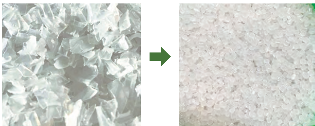
▲食品製造業者より当社が回収したポリプロピレン製容器の粉碎品をグループ会社へ納入し、プラスチック製品の原料となるペレットの製造を行いました。
