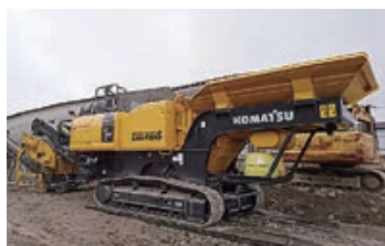
がれき類破碎施設の概要 ●処理能力：680t/日 ●稼働時間：8時間 ●処理品目：がれき類（有筋・無筋）
