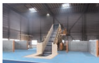
圧縮施設の概要 ●処理能力：232.8t/日 ●稼働時間：24時間稼働 ●処理品目：一般廃棄物（古紙）、廃プラスチック類、紙くず、金属くず
