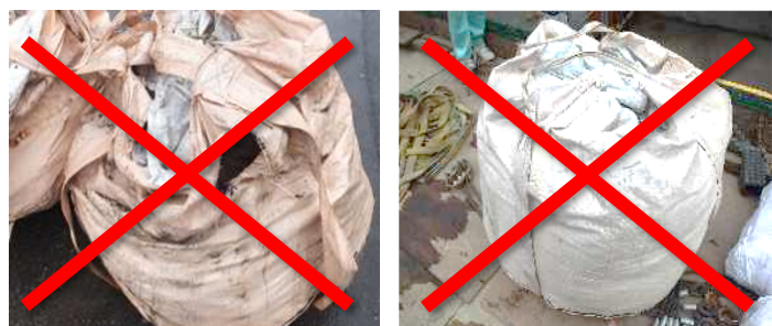
裂け・破れ有り
